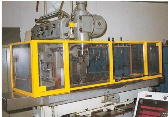
As máquinas e equipamentos que ofereçam risco de ruptura de suas partes, projeção de materiais, partículas ou substâncias, devem possuir proteções que garantam a saúde e a segurança dos trabalhadores.
